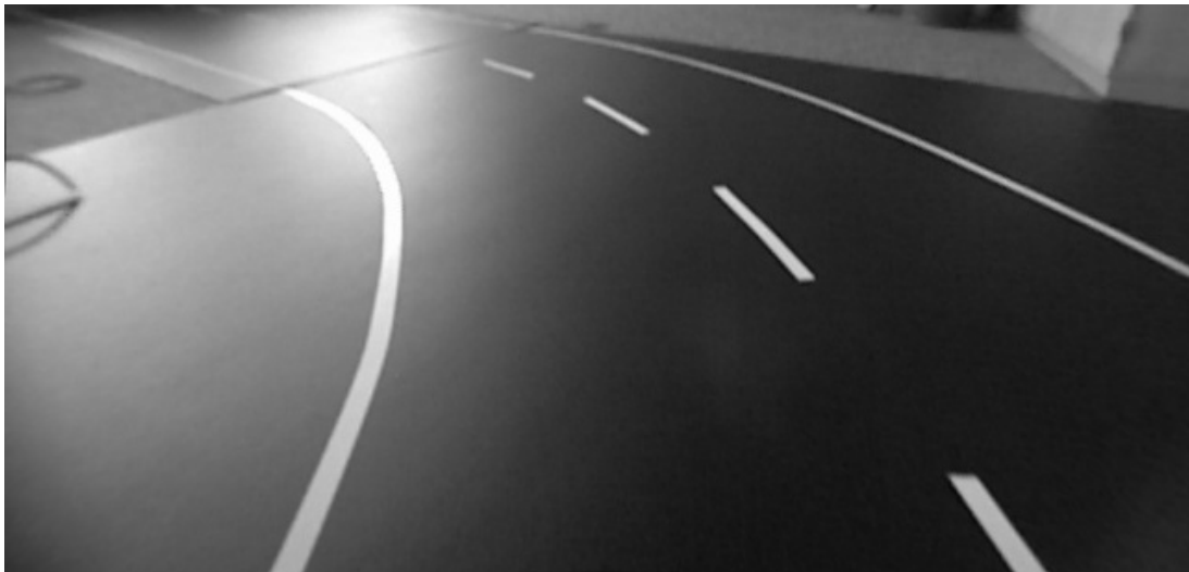
Abbildung 8.1: Ansicht einer Fahrbahn, wie sie auch beim Carolo-Cup Verwendung finden könnte. Die deutliche Abgrenzung zwischen Fahrbahn und Markierungen erleichtert die Erkennung enorm.
